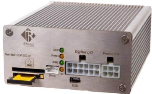
این دستگاه یک کنترلر صنعتی چهار کاناله می باشد که می تواند وضعیت ۴ کanal خروجی را بصورت دیجیتال کنترل نماید. به عبارت دیگر با این دستگاه می توان ۴ خروجی مختلف و مجزا را قطع یا وصل کرد.
